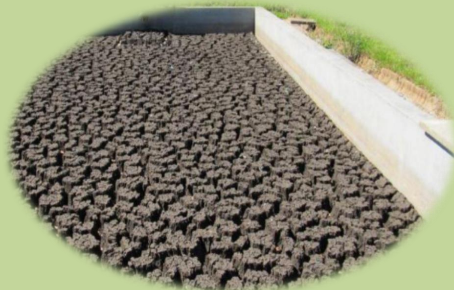
Lodo ETE e ETA
